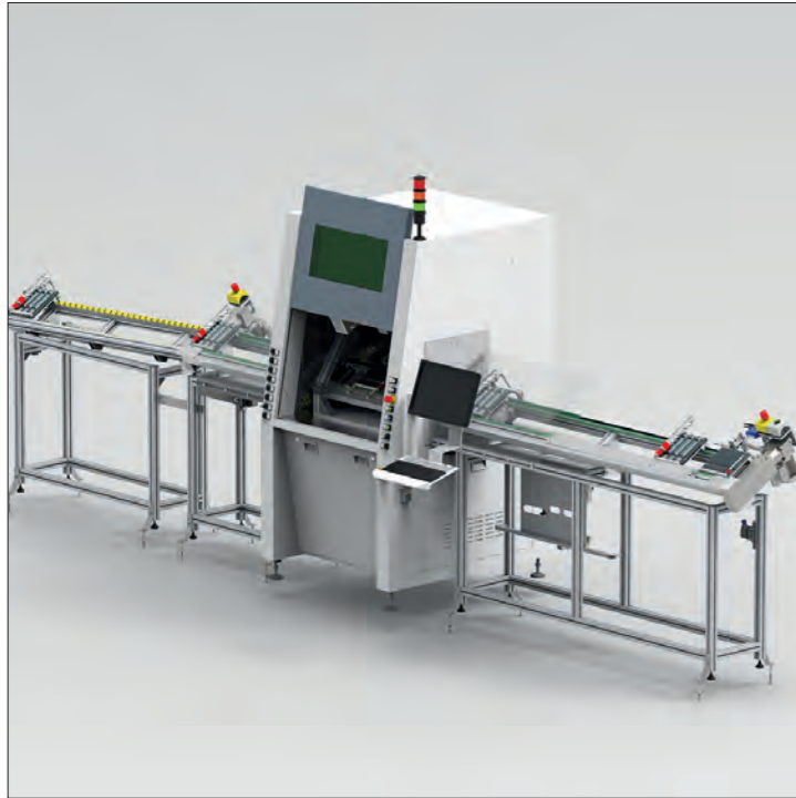
Laserbeschriftung von Bohrern
