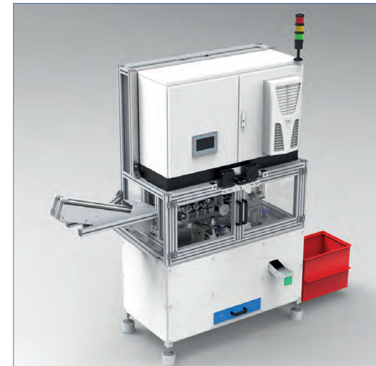
taktile Merkmalprüfung (Gewindeprüfung)
